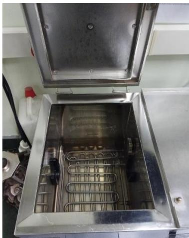
Figura 15 . Placa calefactora del equipo Linitest de laboratorio
