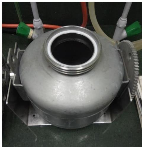
Figura 16. Reactor del equipo Linitest de laboratorio
